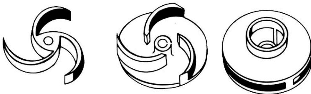
شکل ۲-۵ انواع پروانه های جریان شعاعی (بسته، نیم باز و باز)
