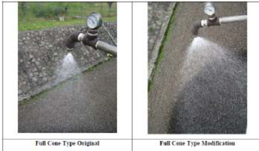
شکل ۱-۲. تغییر نازل‌های کندانسور در جهت عملکرد بهتر
