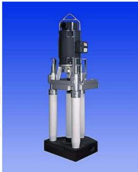
شکل ۳-۳. نمایی ساده از پمپ‌های گردشی
