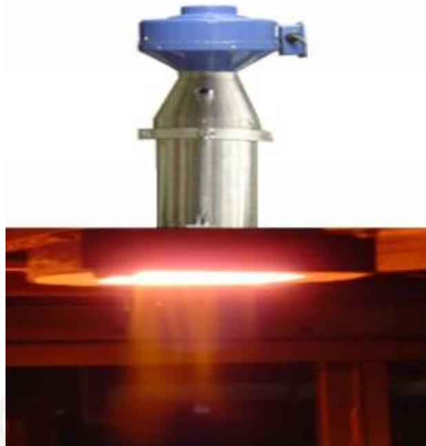
شکل ۳-۶. شمایی از فرآیند گرمایش با استفاده از پلاسما
