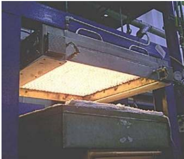
شکل ۳-۵. شمایی از فرآیند ذوب با استفاده از تابش مادون قرمز
