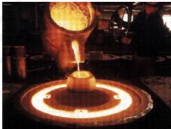
شکل ۱-۲. بار ریزی فلز در قالب
