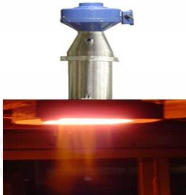
شمایی از فرآیند گرمایش با استفاده از پلاسما
