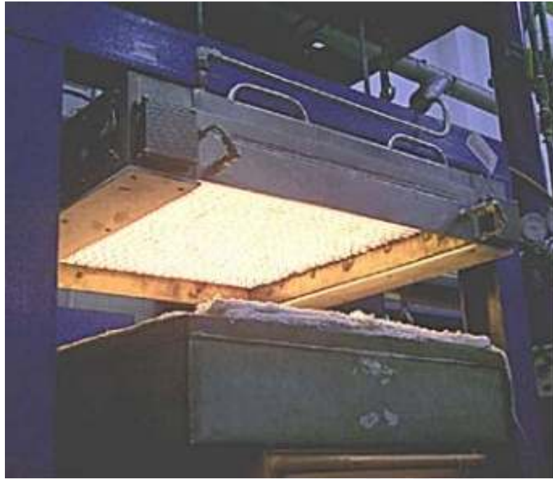
شمایی از فرآیند ذوب با استفاده از تابش مادون قرمز [۱]
