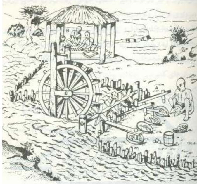
شکل ۱-۱. پتک های ضربه ای اولیه چینیان جهت خرد کردن فلدسپارها
