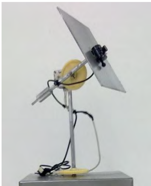
شکل (2) سیستم ردیاب خورشیدی با دو درجه آزادی [20]
