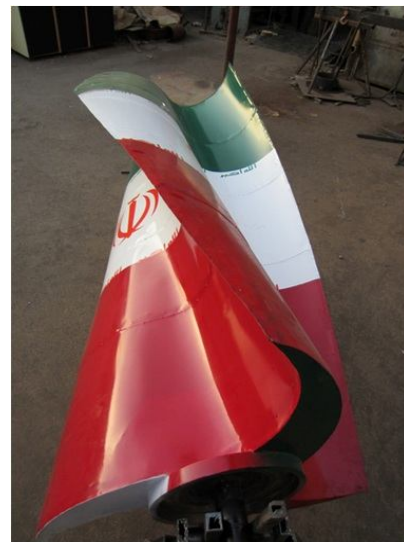
شکل (6) پره توربین ساخته شده در دانشگاه آزاد خمینی شهر.
