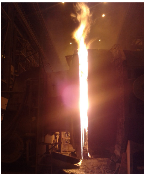
شکل (2) فاصله‌ی زیاد بین بشقابک و پاتیل و اتلاف انرژی از این فاصله
