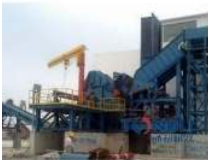
شکل ۵-۱۳. خط تولید قراضه خرد شده
