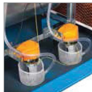
نمای پمپ آب
